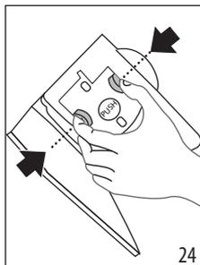
4. Нажмите вниз две цветные кнопки расщепления (рис. 24) и одновременно потяните заварочный узел наружу.
