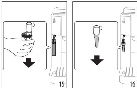
3. Потяните вниз и снимите распылитель (A18) (рис. 16).
