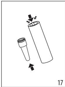
5. Вставьте на место распылитель и установите на него капучинатор. Протолкните его вверх и поверните по часовой стрелке до зацепления.
