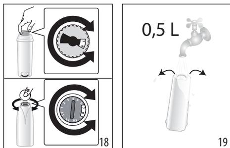
2. Чтобы активировать фильтр, заливайте водопроводную воду в центральное отверстие фильтра, пока она не начнет стекать из боковых отверстий в течение более одной минуты (рис. 19).
