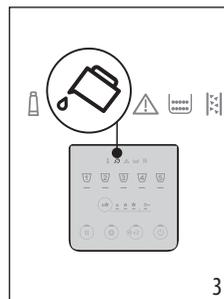
2. На контрольной панели (В) загорится индикатор
