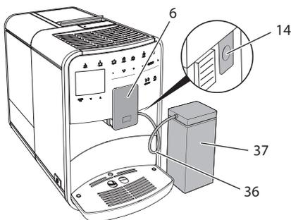
Рис. 12: Подключение емкости для молока к аппарату
