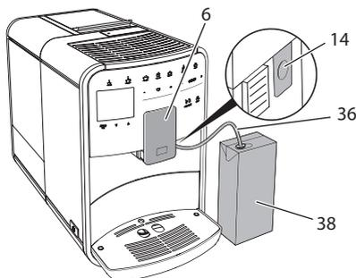
Рис. 13: Подключение трубки для молока к аппарату
